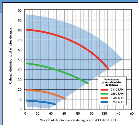
\*NOTA: La tabla anterior demuestra las velocidades de rendimiento con las velocidades preestablecidas de fábrica de 750 RPM, 1500 RPM, 2350 RPM y 3110 RPM. Sin embargo, las velocidades de circulación también pueden programarse de forma personalizada entre los rangos de 400 RPM y 3450 RPM, como indica el tinte azul.
